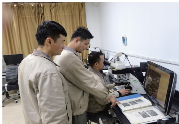
技术人员正在对工件材料进行金相组织检测
